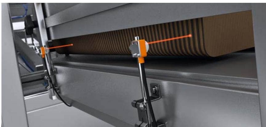
**Rilevamento del livello nel magazzino di scatoloni**
